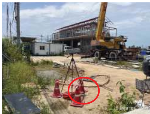
ภาพที่ 3.5.5-1 การเก็บตัวอย่างเพื่อการตรวจวัดความสั่นสะเทือน
